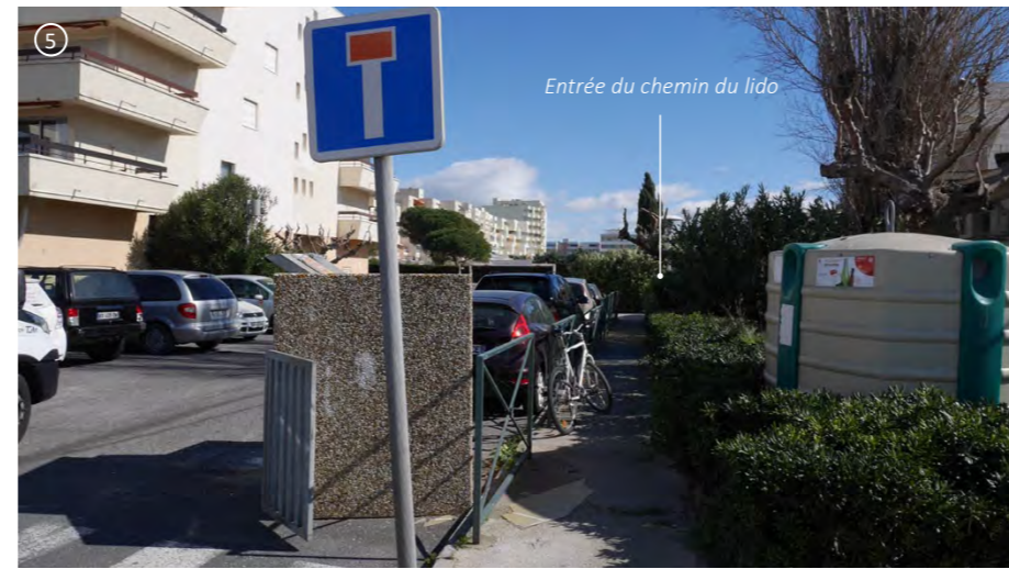
Accès complètement encombré et invisible vers le chemin du Lido, dû au trottoir trop étroit, à l'absence de signalétique, à l'implantation des poubelles et aux stationnements
