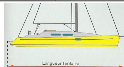
La longueur de référencement prise en compte à Carnon est la longueur **HORS TOUT** : soit la longueur d'encombrement maximum du navire (moteur, balcon avant, tableau arrière, davier d'étrave, plage, bout dehors, embases, etc...) selon schéma ci-dessus.
